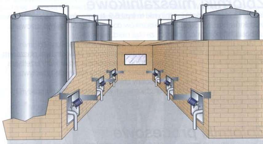
Rys. 6.9.1 Tankosilosy zainstalowane na zewnątrz budynku z włazami umieszczonymi we wnękach ścian zadaszonego pomieszczenia
