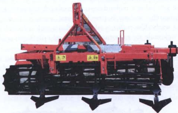
Fot. 4. Gruber z wałem strunowym. Fot. M. Konopiński
